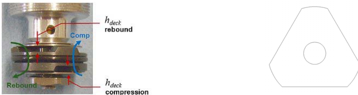
fig.13: a sx vediamo la classica BV della forcella (in posizione rovesciata rispetto al reale, da manuale RS), dove sotto il pistone c'è una check-valve e sopra la pila di lamelle. Sono specificati i parametri h_{deck} per la compressione ed il ritorno. A dx vediamo una "delta shim".
